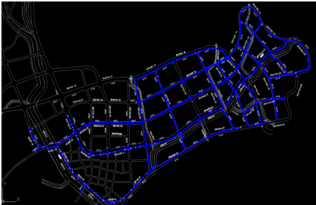
图1.2-2 潭柘寺中心区配水管网布置图
