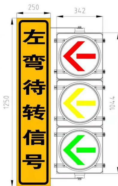
图 11 左转二次灯提示牌样式及安装示意图
