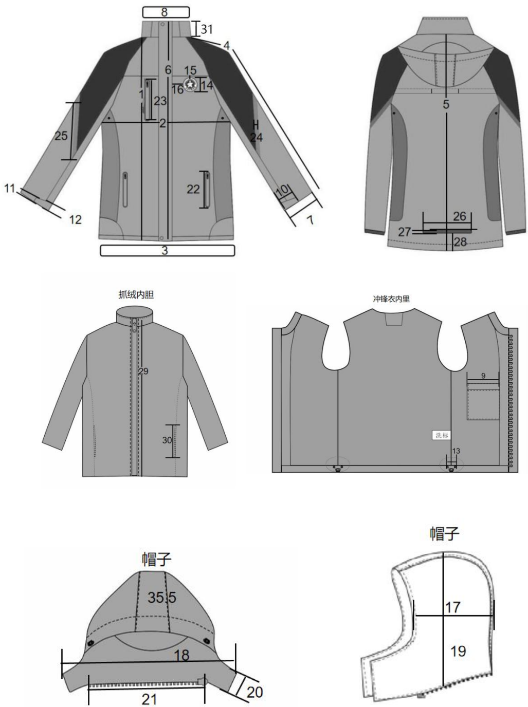
图 2-2-2 冲锋衣成品规格尺寸测量图
